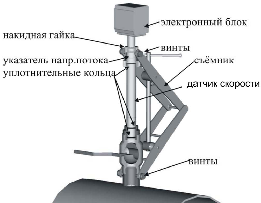
Рисунок 15 — Порядок установки преобразователя скорости
