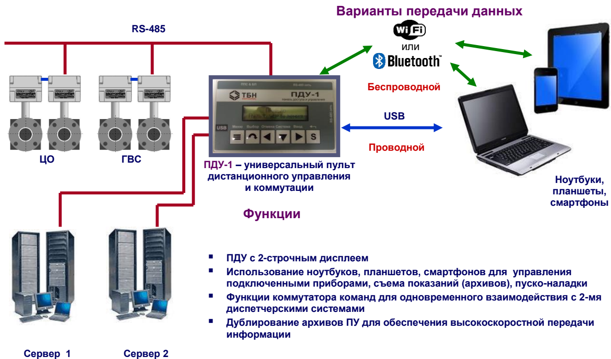
Рисунок 2 — Использование панели ПДУ-1 для управления КМ-5.
